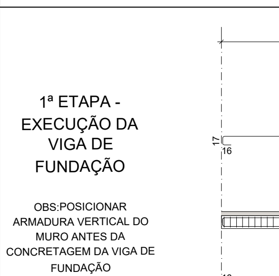
ARMADURAS DA PAREDE 05 Vista 1/75 e Cortes 1/30
